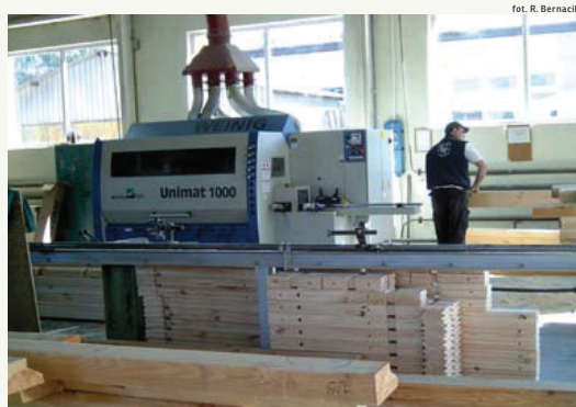
Profilowane elementy ścian są obrabiane na strugarce Weing Unimat 1000.
